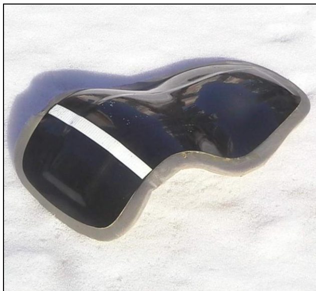
Рис. 58. Углепластиковая жесткая спинка для подвесной системы.
