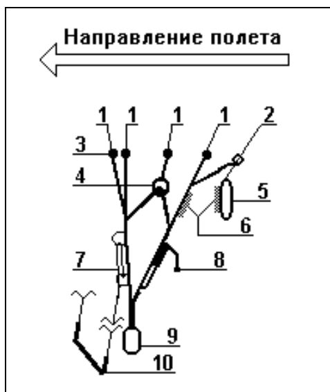
Рис. 55. Пример конструкции свободных концов.
