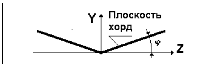
Рис. 32. Угол поперечного V крыла.
