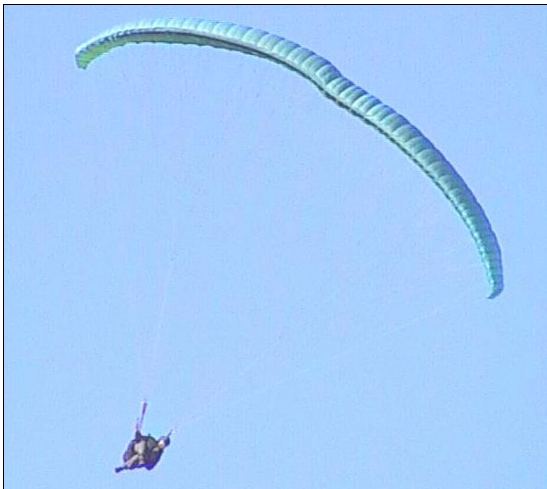
Рис. 67. Выполнение разворота балансирующим способом. Обратите внимание на характерный изгиб в центре купола, возникающий из-за перекашивания свободных концов.
