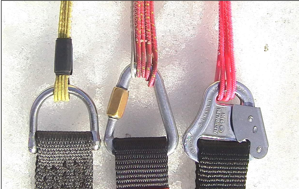
Рис. 56. Примеры карабинов-коннекторов строп.
