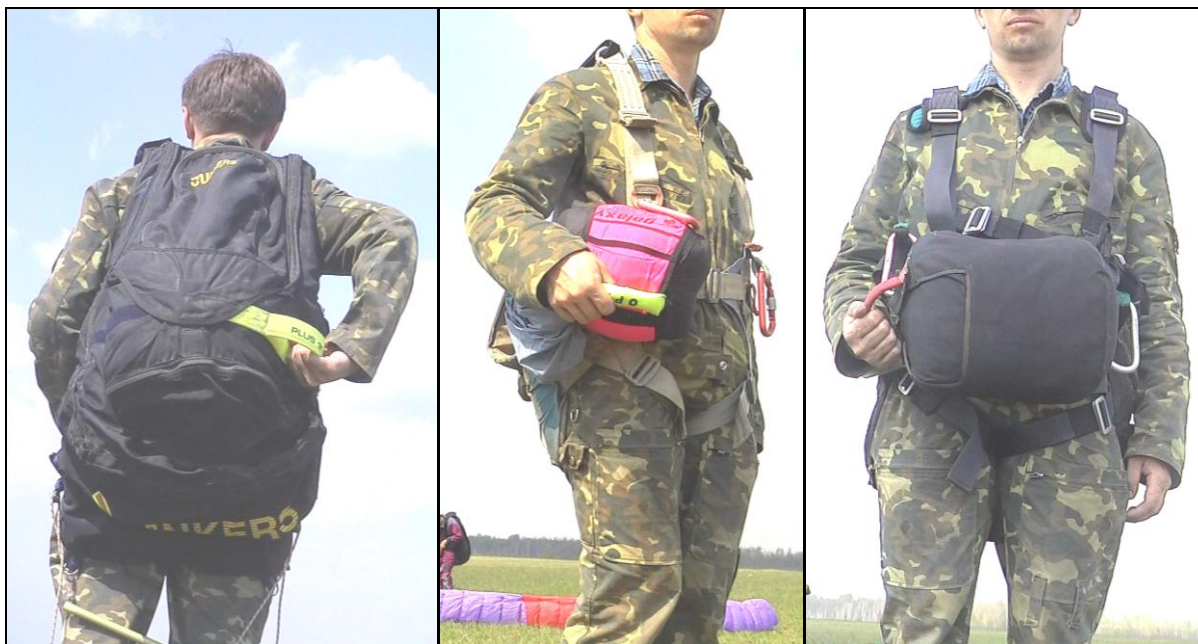
Рис. 99. Парашют встроен в подвесную систему.
