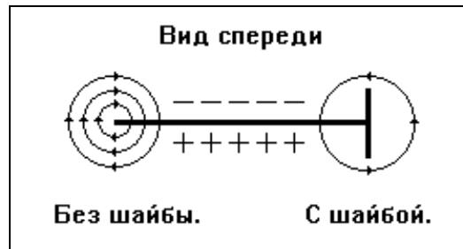
Рис. 43. Уменьшение индуктивного сопротивления с помощью концевых шайб.
